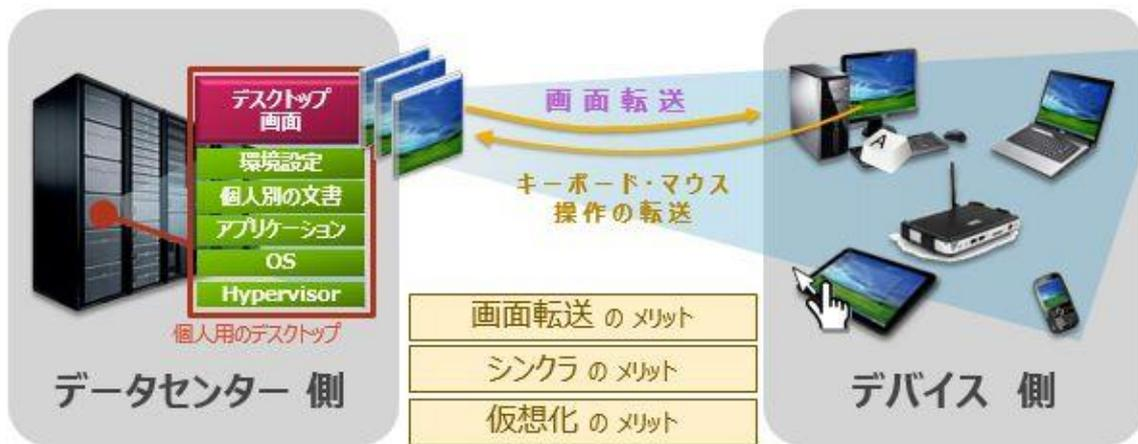
図 1 仮想デスクトップインフラストラクチャ(VDI)環境への接続イメージ
