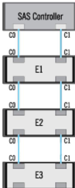
Geht der Kommunikationskanal zwischen Konnektor und erstem Gehäuse verloren, geht die Konfiguration des redundanten Pfads an sich verloren. In diesem Fall wird der Funktionszustand des logischen Konnektors als kritisch angezeigt. Navigieren Sie zur Seite **Informationen/Konfiguration** des logischen Konnektors, um Details des [Pfadzustands](#) anzuzeigen. Eine kurze Zusammenfassung dieses Vorgangs finden Sie in der folgenden Tabelle:
