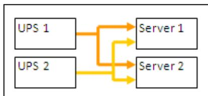
图 81. 冗余电源的冗余模式
