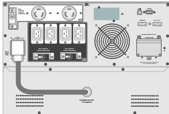
**1** Подключите кабель МВБ к разъему батарей ИБП.
