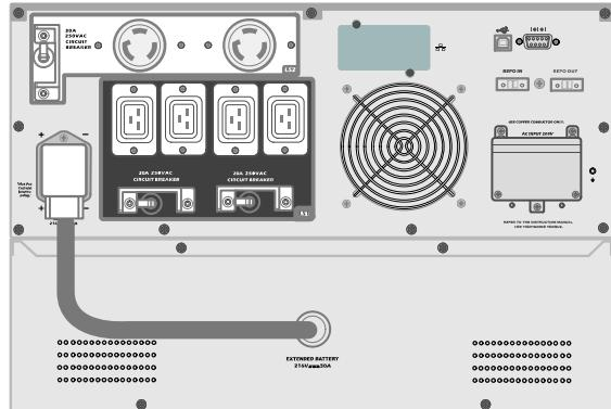
1 將 EBM 電纜插入 UPS 電池接頭。
