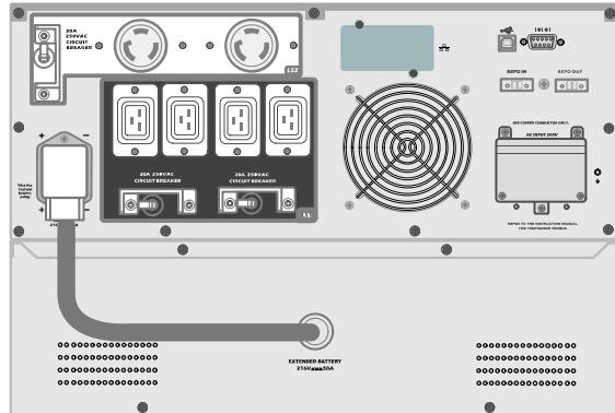
**①** 将EBM电缆插入UPS电池连接器。
