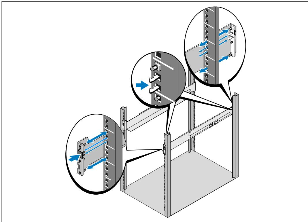
注意：方孔機架和無螺紋的圓孔機架的操作說明相同。導軌適用於這兩種機架。
