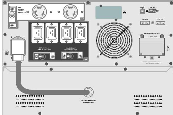
① EBM 케이블을 UPS 배터리 커넥터에 꽂으십시오.
