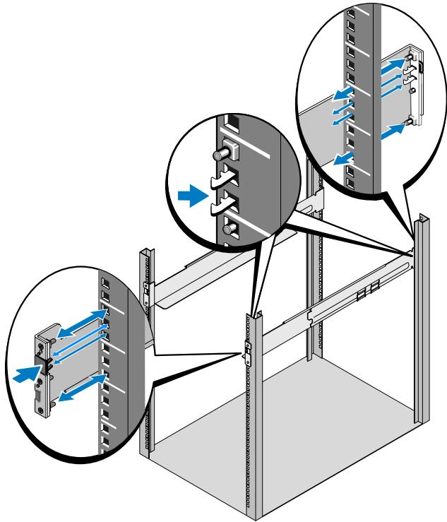
**!** 주 : 사각 구멍 랙과 나사판 없는 원형 구멍 랙에 대해 설치 지침은 동일합니다. 레일은 두 종류의 랙에 모두 맞습니다. 원형 구멍 랙은 그림에서 볼 수 있습니다.
