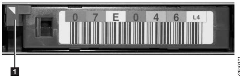
Figure 45. Taquet de verrouillage des cartouches
