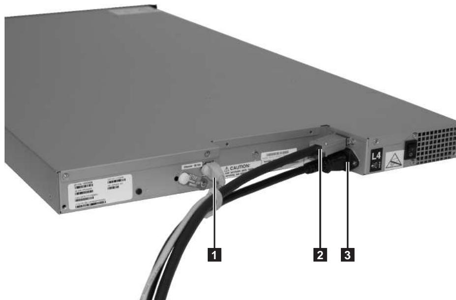
Figure 28. Branchement du câble d'interface
