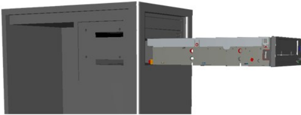
Рис. 5. Установка внутреннего ленточного накопителя
