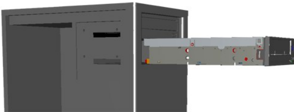
Abbildung 5: Installieren des internen Bandlaufwerks
