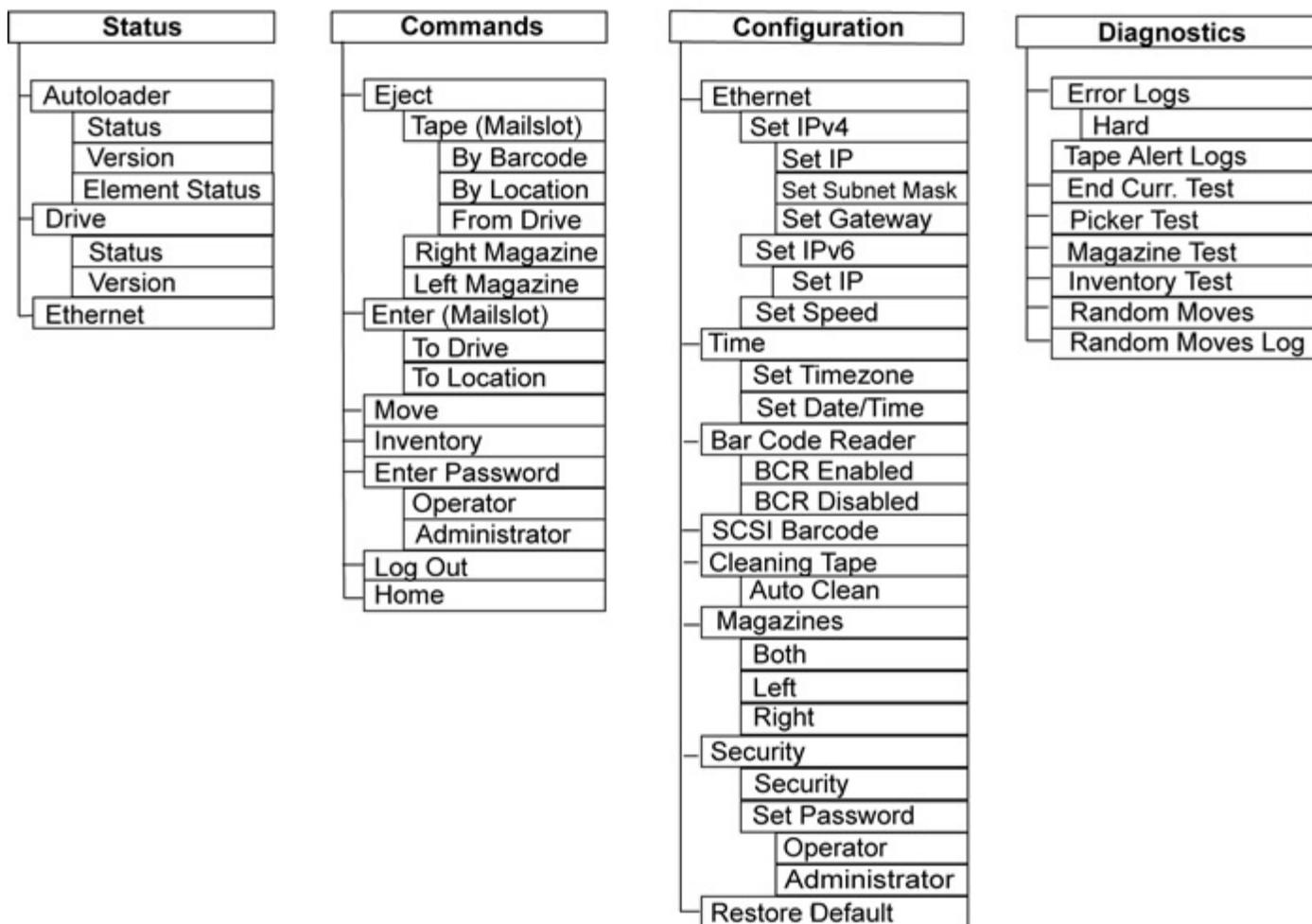
Para configurar el cargador automático Dell PowerVault 124T LTO6 SAS, debe verificar la configuración de los siguientes componentes:
