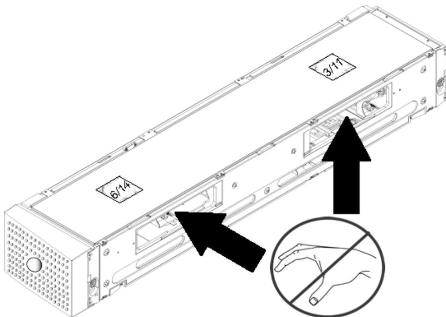
**⚠ Precaución:** Se recomienda que retire completamente el depósito para cargar y descargar cartuchos. Si no se retira completamente el depósito, no lo gire.
