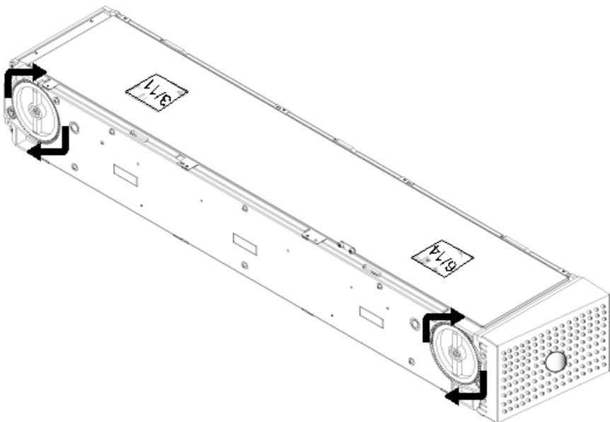
No gire el depósito insertando su mano y empujando los cargadores de cartuchos. Puede usar las aberturas del depósito para cargar y descargar cartuchos de las ocho ranuras dentro de cada depósito.
