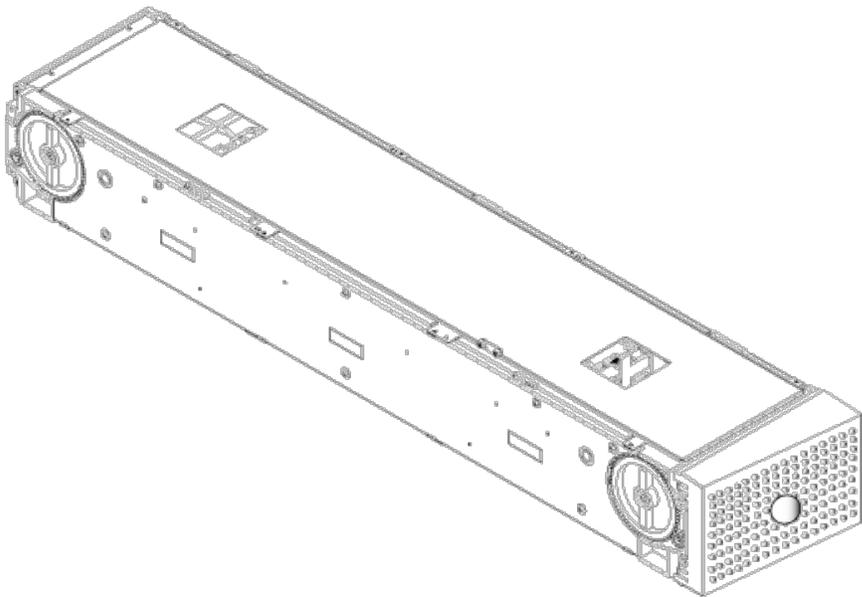
El cargador automático no funcionará a menos que los alojamientos de ambos depósitos estén ocupados adecuadamente ya sea con un depósito o con un depósito vacío. Una forma de cerrar las aberturas es utilizar dos depósitos. Si se utiliza sólo un depósito, se debe llenar la abertura del otro depósito con un depósito vacío para que la unidad pueda funcionar.
