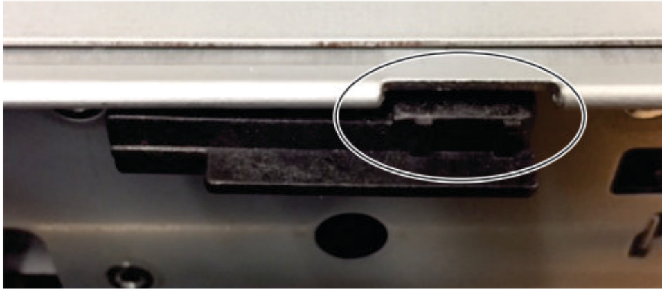
図 30. 上部カバーのセンサー
