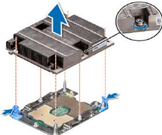
3. Mettez de côté le module du processeur et du dissipateur avec le côté processeur vers le haut.
