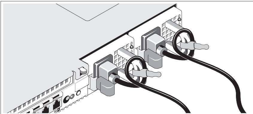
システムの電源ケーブルをループ状に曲げ（図を参照）、付属のストラップでケーブルを固定します。
