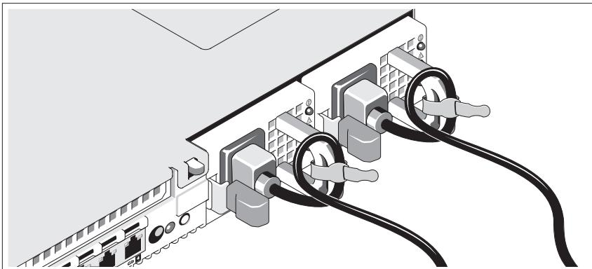
Tekuk kabel daya sistem secara melingkar seperti ditunjukkan pada gambar kemudian kencangkan kabel dengan pengikat yang tersedia.
