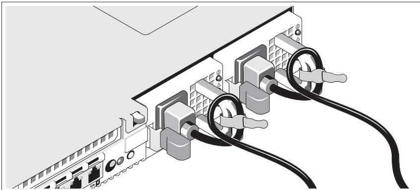
그림과 같이 시스템 전원 케이블을 고리 안으로 구부려서 제공된 끈으로 케이블을 고정합니다.
