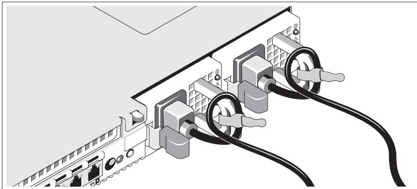
如图所示，将系统电源电缆弯曲成一个环路，并使用所提供腕带固定该电缆。
