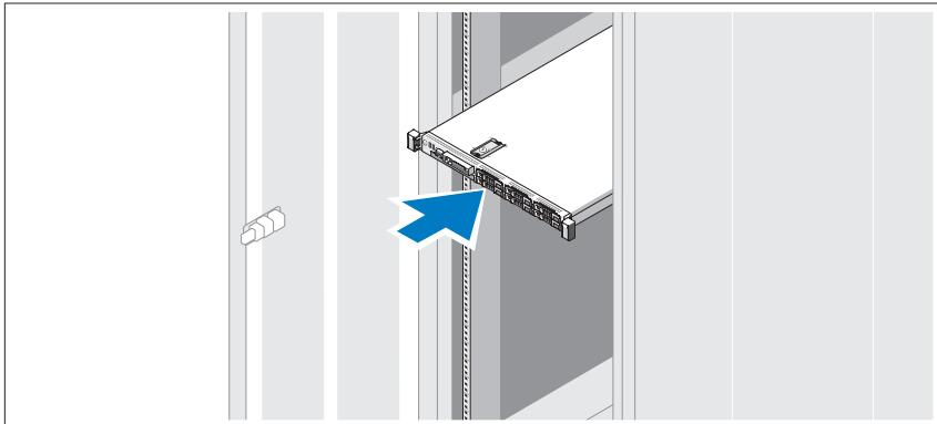
遵循系统随附的安全说明和机架安装说明组装滑轨并在机架中安装系统。
