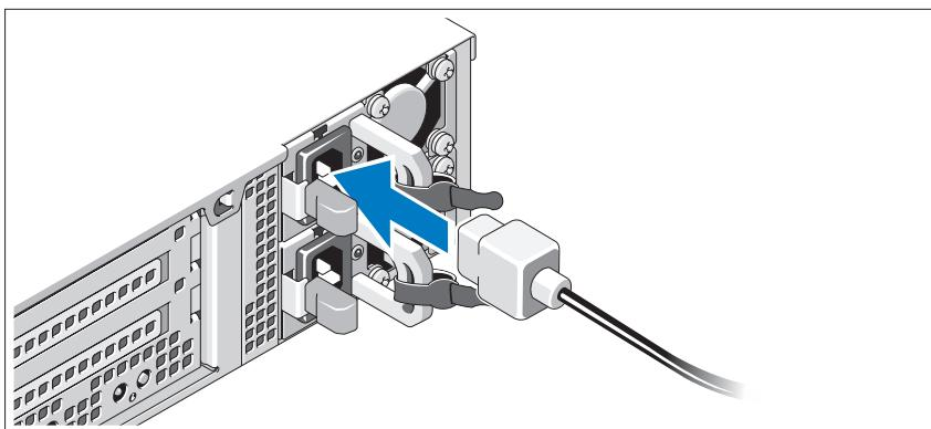
Hubungkan kabel daya sistem ke sistem dan, jika menggunakan monitor, hubungkan kabel daya monitor ke monitor.
