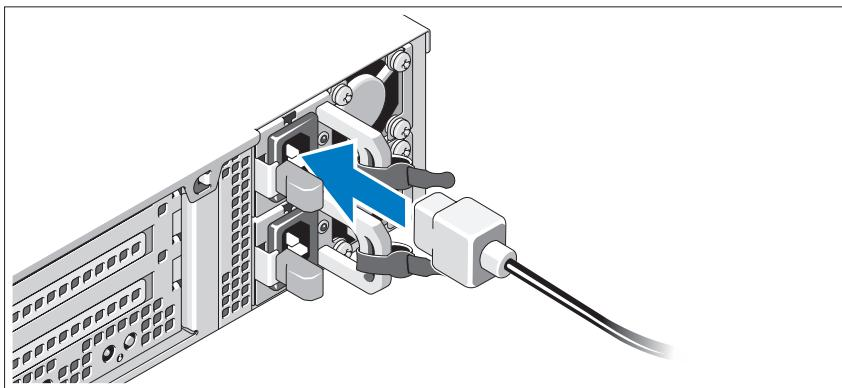
将系统电源电缆连接至系统，如果使用显示器，则将显示器电源电缆连接至显示器。
