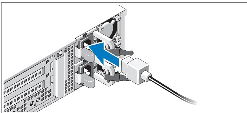
시스템의 전원 케이블을 시스템에 연결하고, 모니터를 사용하는 경우 모니터의 전원 케이블을 모니터에 연결합니다.
