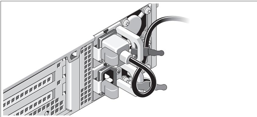
システムの電源ケーブルをループ状に曲げ（図を参照）、付属のストラップでブラケットに固定します。電源ケーブルのもう一方の端をアースされたコンセントまたは無停電電源装置（UPS）や配電装置（PDU）などの別の電源に接続します。
