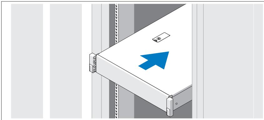
遵循系统随附的安全说明和机架安装说明，在机架中组装滑轨并安装系统。
