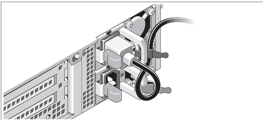
Faites une boucle comme indiqué dans l'illustration, puis fixez-le à l'aide de la sangle fournie. Branchez ensuite l'autre extrémité du câble d'alimentation sur une prise secteur mise à la terre ou sur une source d'alimentation autonome (telle qu'un onduleur (UPS) ou une unité de distribution de l'alimentation(PDU)).
