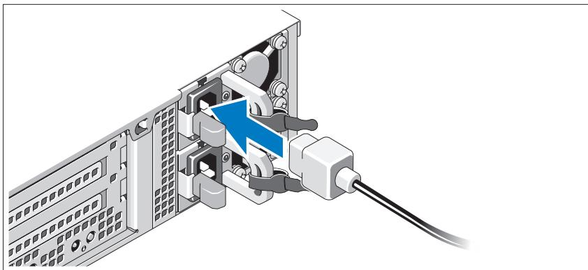
Connectez le ou les câbles d'alimentation au système et, si vous utilisez un moniteur, connectez le câble d'alimentation du moniteur à ce dernier.
