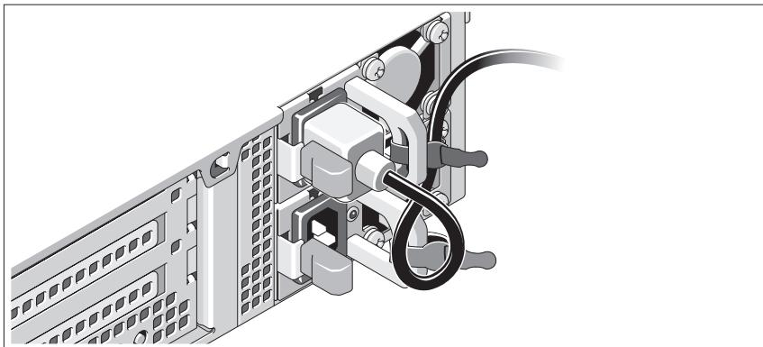
Dobre o cabo de alimentação do sistema em forma de laço conforme a ilustração e prenda-o com a tira fornecida. Conecte a outra extremidade do cabo de alimentação a uma tomada elétrica aterrada ou a uma fonte de energia separada como, por exemplo, uma UPS (Uninterruptible Power Supply [Fonte de Alimentação Ininterrupta]) ou uma PDU (Power Distribution Unit [Unidade de Distribuição de Energia]).
