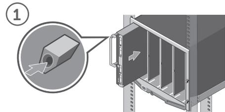
1 Começando a partir da esquerda, instale as lâminas no compartimento. Empezando por la izquierda, instale los blades en el chasis.
