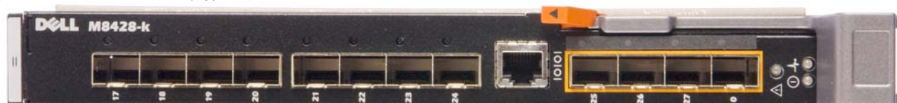
图 1 M8428-k 的端口侧
