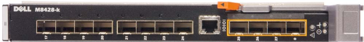
FIGURA 1 Lateral de los puertos de M8428-k
