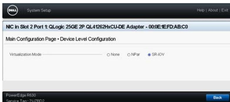
图 11-2. SR-IOV 的系统设置：设备级配置
