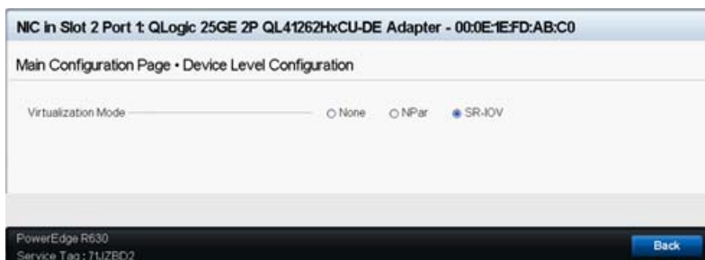
Figure 11-9. Configuration système pour SR-IOV : Périphériques intégrés
