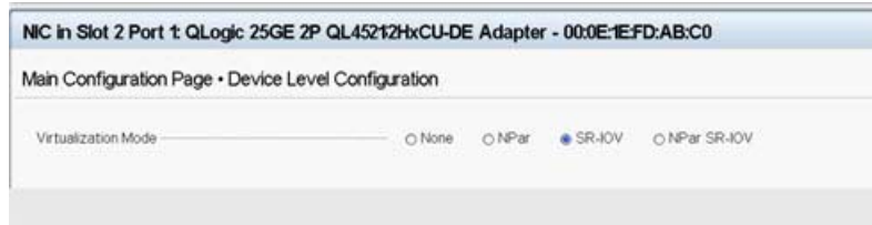
Figura 8-9. System Setup for SR-IOV: Integrated Devices (Configuración del sistema Dell para SR-IOV: Dispositivos integrados)
