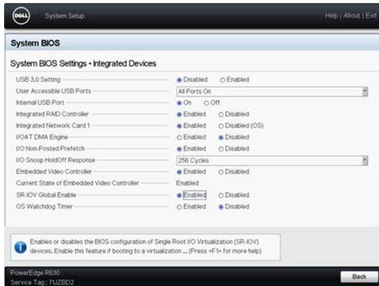
Figura 8-1. System Setup for SR-IOV: Integrated Devices (Configuración del sistema Dell para SR-IOV: Dispositivos integrados)
