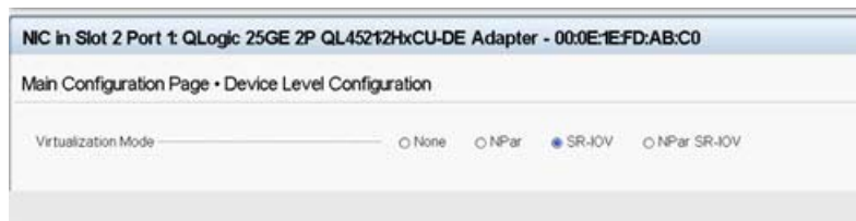
Figura 8-2. System Setup for SR-IOV: Device Level Configuration (Configuración del sistema Dell para SR-IOV: Configuración de nivel de dispositivo)
