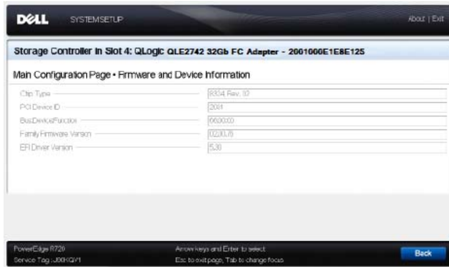
Figura 3-14. Dell System Setup (Configuração do sistema Dell): Firmware and Device Information (Informações sobre firmware e dispositivo)
