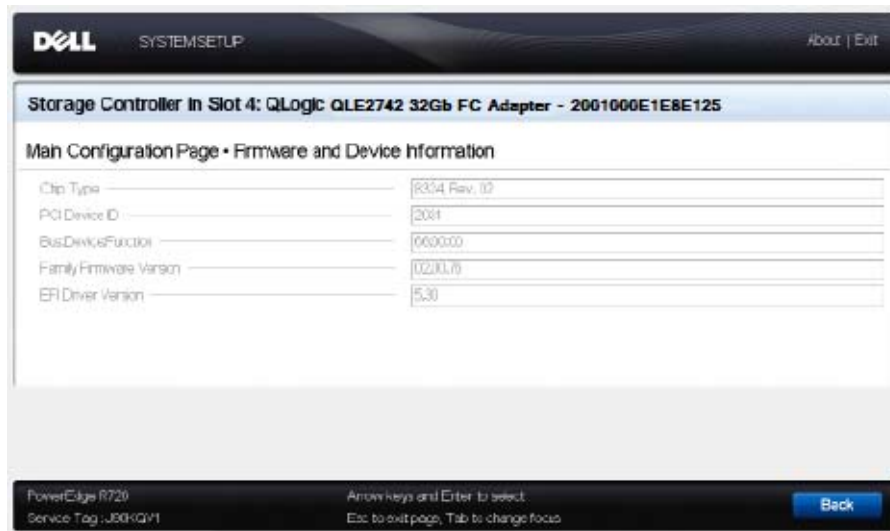
Figure 3-14. Configuration système Dell : Informations sur le micrologiciel et les périphériques
