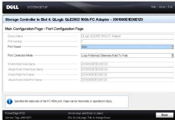
Figura 3-13. Dell System Setup (Configuração do sistema Dell): Configuração de porta
