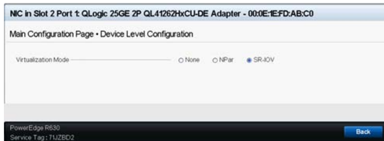
Figura 11-9. Configuração do sistema para SR-IOV: Dispositivos integrados
