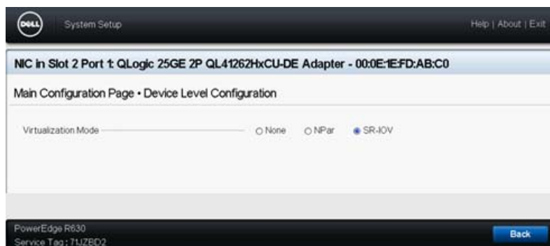
Figura 11-2. Configuração do sistema para SR-IOV: Configuração do nível do dispositivo
