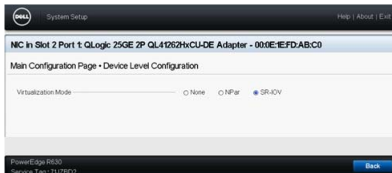
Figura 11-2. System Setup for SR-IOV: Device Level Configuration (Configuración del sistema para SR-IOV: Configuración de nivel de dispositivo)
