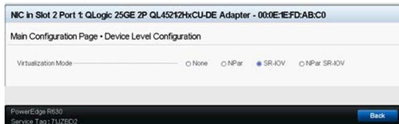
Figura 8-9. System Setup for SR-IOV: Integrated Devices (Configuración del sistema Dell para SR-IOV: Dispositivos integrados)
