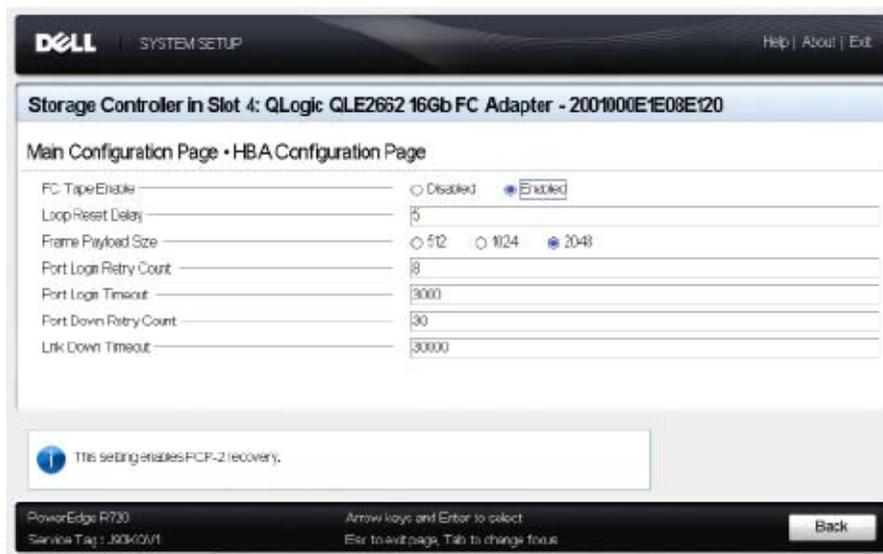
**Figure 3-16. Configuration système Dell : Configuration des adaptateurs HBA**
