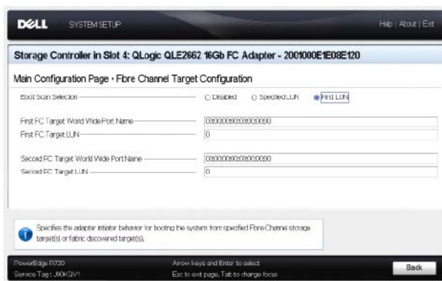
Ilustración 3-15. Configuración del destino Fibre Channel
