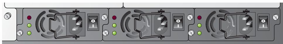
Illustration 7 Alimentations de 400 W installées
