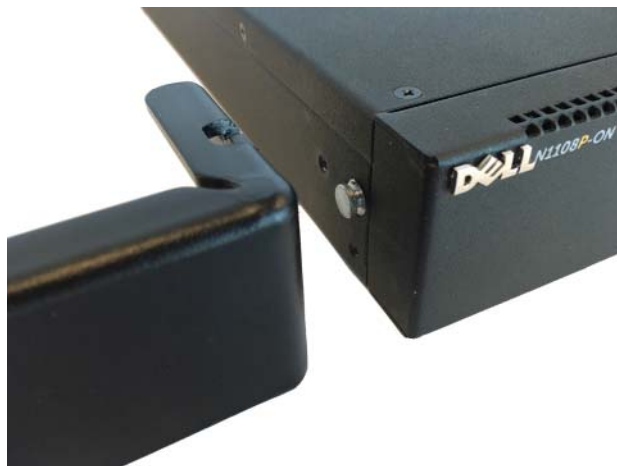
Abbildung 1-6. Anbringen der Halterungen
