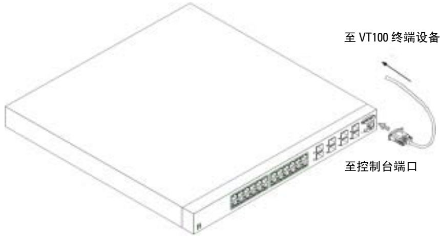
图 1-3. 连接至控制台端口
