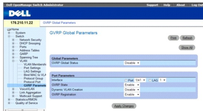
Рис. 7-60. Страница GVRP Global Parameters (Общие параметры GVRP)
