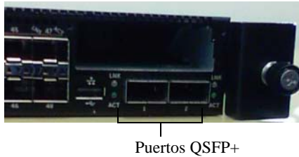
Ilustración 1. Panel frontal de Dell Networking N4000
