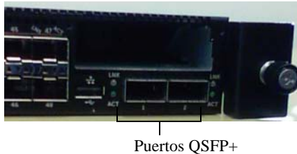
Ilustración 1. Panel frontal de Dell Networking N4000
