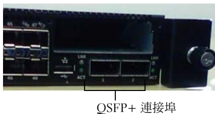
圖 1. Dell Networking N4000 前板
