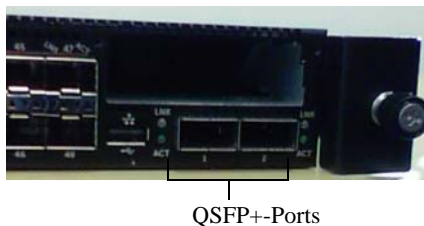
Abbildung 1. Dell Networking N4000 – Vorderseite
