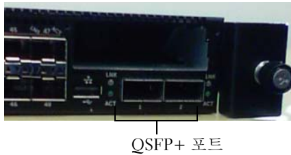
그림 1. Dell Networking N4000 전면 패널
