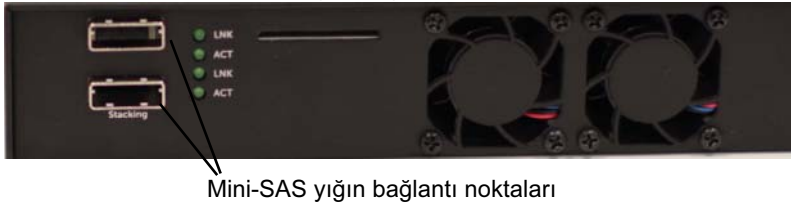
Şekil 1-6. N2048 Mini-SAS Yığın Bağlantı Noktaları ve Fanlar
