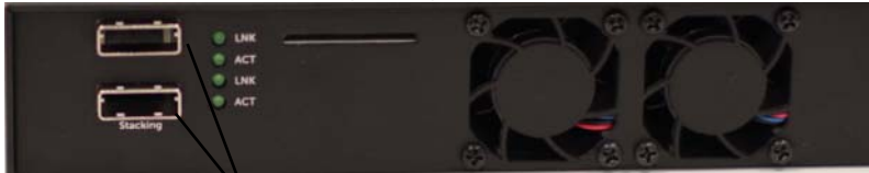
Şekil 1-6. N2048 Mini-SAS Yığın Bağlantı Noktaları ve Fanlar
