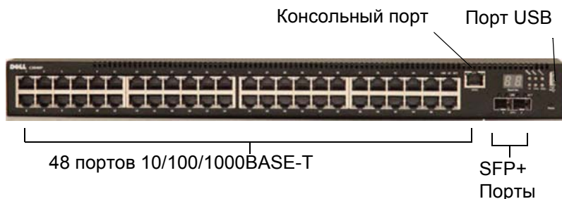
Рисунок 1-1. Серия N2048 с 48 портами 10/100/1000BASE-T (передняя панель)
