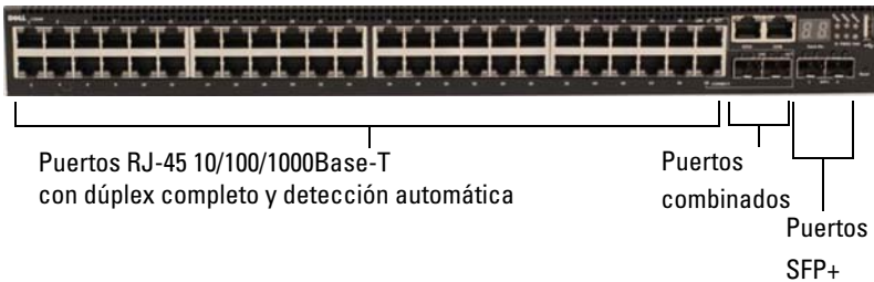
Ilustración 1-13. N3048 con 48 puertos 10/100/1000Base-T (panel frontal)
