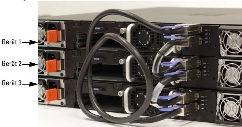
Abbildung 1-23. Verbinden eines Switch-Stacks
