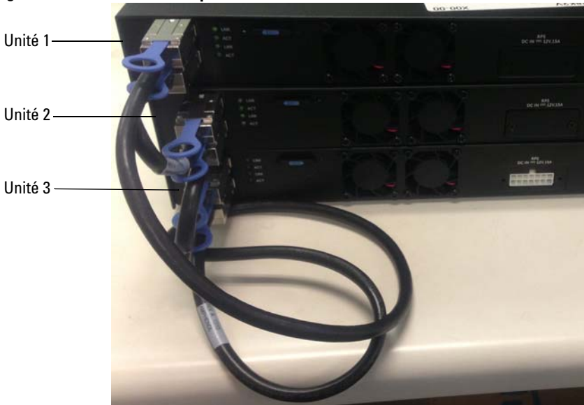
Figure 1-8. Connexion d'une pile de commutateurs
