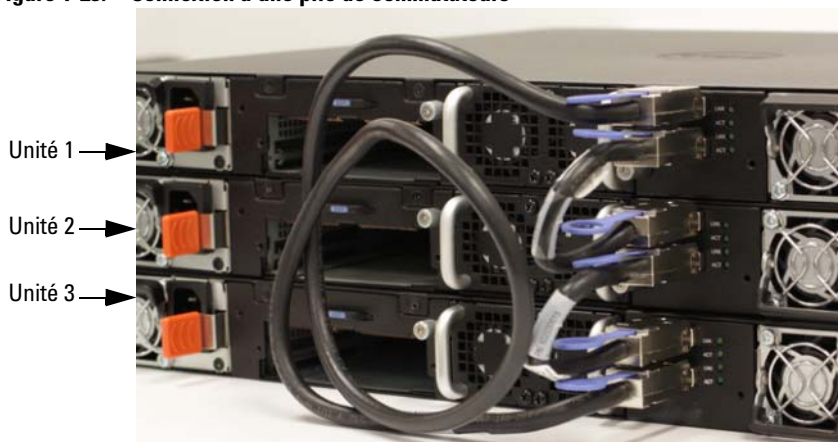
Figure 1-23. Connexion d'une pile de commutateurs
