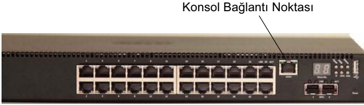
Şekil 1-10. N2024P Konsol Bağlantı Noktalı Ön Panel
