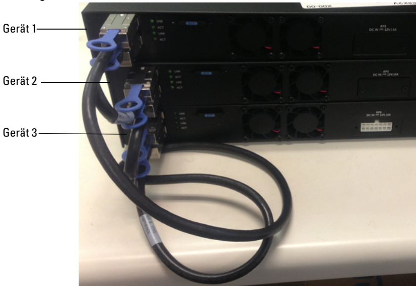
Abbildung 1-8. Verbinden eines Switch-Stacks
