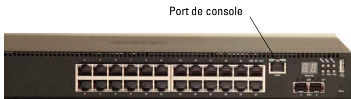
Figure 1-10. Panneau avant N2024P avec port de console
