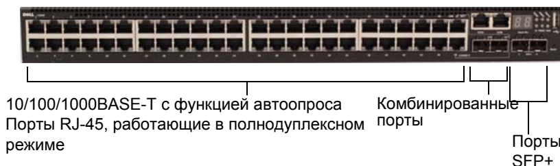
Рисунок 1-13. Серия N3048 с 48 портами 10/100/1000BASE-T (передняя панель)
