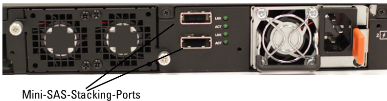
Abbildung 1-18. N3048 Mini-SAS-Stacking-Ports - Nahaufnahme
