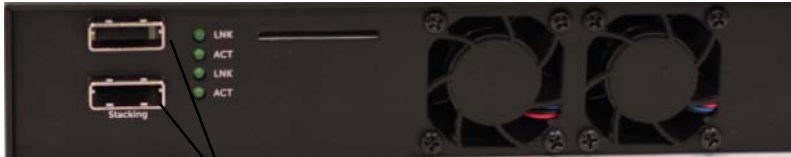
Şekil 1-6. N2048 Mini-SAS Yığın Bağlantı Noktaları ve Fanlar
