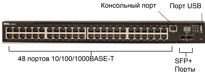
Рисунок 1-1. Серия N2048 с 48 портами 10/100/1000BASE-T (передняя панель)
