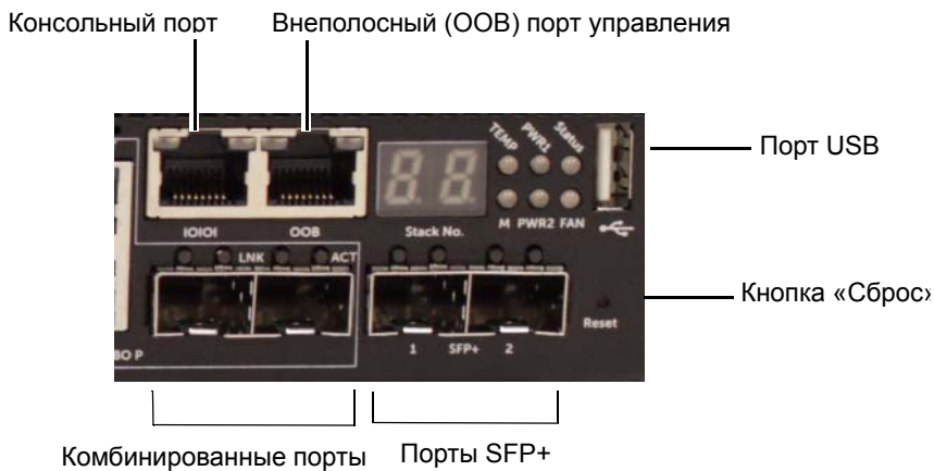
Рисунок 1-14. Дополнительные порты серии N30xx
