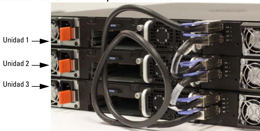
Ilustración 1-23. Conexión de una pila de conmutadores
