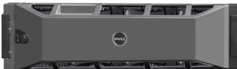
图 1-2: PS6010 前面板 (不带挡板)
