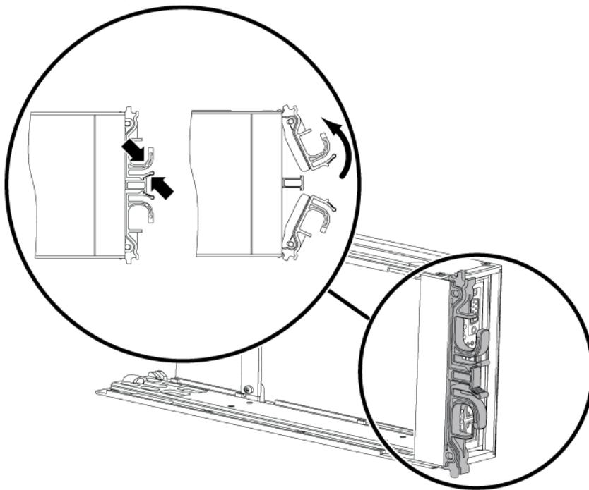
2. Halten Sie die Riegel fest und schieben Sie das Steuermodul vorsichtig aus dem Schacht. Siehe Abbildung 3-5.
