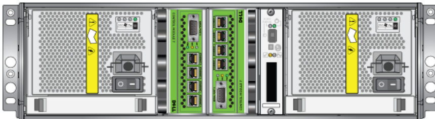
图 3-6: 正确的控制模块方向
