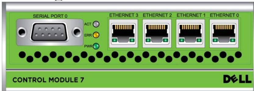
1度アクティブ（ネットワークトラフィックを提供）になるのは1つのコントロールモジュールのみです。セカンダリ（冗長）コントロールモジュールは、アクティブなコントロールモジュールのキャッシュデータをミラーリングします。アクティブなコントロールモジュールに障害が発生すると、セカンダリコントロールモジュールがネットワーク処理を受け継ぎます。
