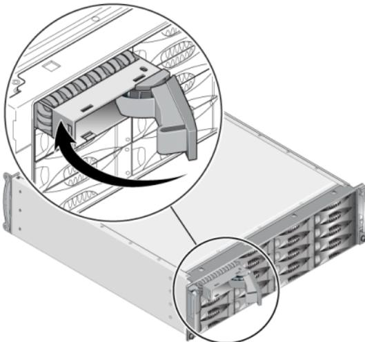
2-2 ページの「ディスク LED について」で説明されているように、前面パネルの LED を調べて、新しいディスクが使用可能かを確認します。
