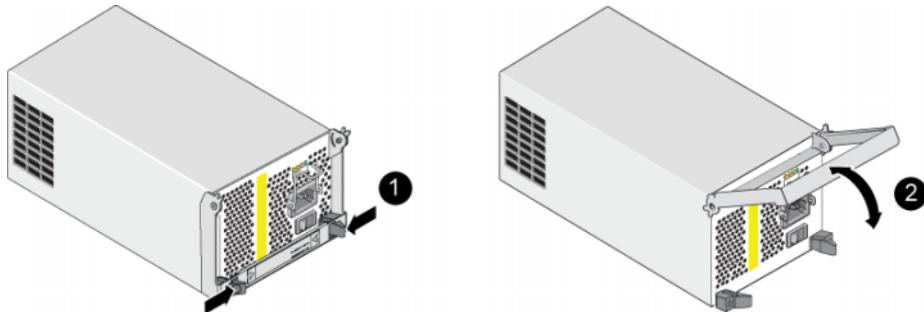
4. ハンドルを持ちながら、モジュールをスロットから引き抜きます。図 4-3 電源装置冷却モジュールの取り外しを参照してください。
