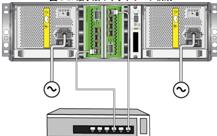
この構成では、コントロールモジュールのフェイルオーバーには対応しますが、障害ポイントとなる危険性があります（たとえば、アクティブコントロールモジュールに接続しているネットワークケーブルが外れる場合など）。したがって、複数のネットワークインタフェースを別々のネットワークスイッチに接続することをお勧めします。
