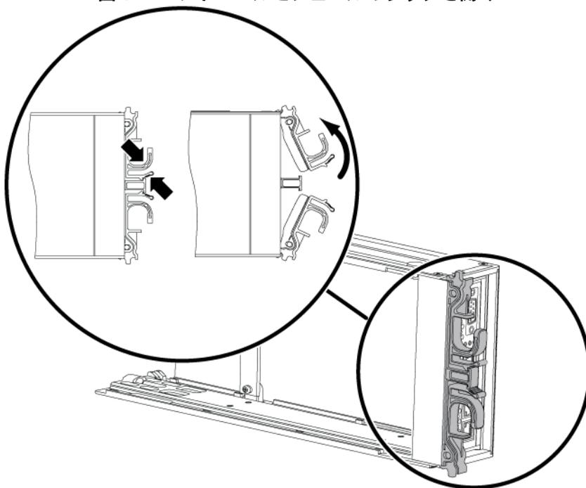
2. ラッチを支えながら、コントロールモジュールをスロットから慎重に引き抜きます。図 3-5 コントロールモジュールの取り外しを参照してください。
