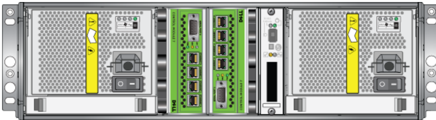
Abbildung 3-6: Richtige Ausrichtung der Steuermodule
