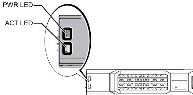
图 7: 2.5 英寸驱动器上的 LED 指示灯
