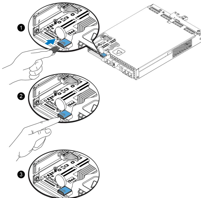
3. 将控制模块安装到阵列中。请参阅 [第 23 页上的安装控制模块](#)。
