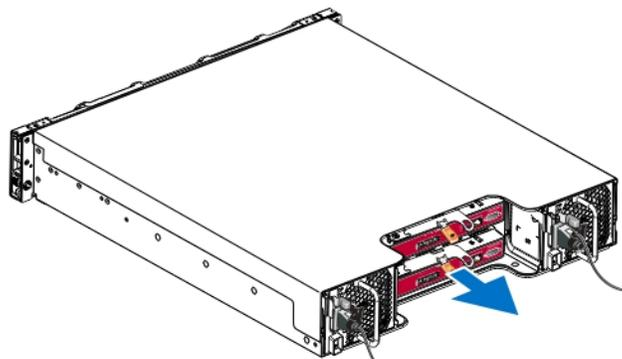
3. 将控制模块放置在能够防止静电放电的平坦表面上。为避免损坏，请勿在控制模块上放置任何物品。
