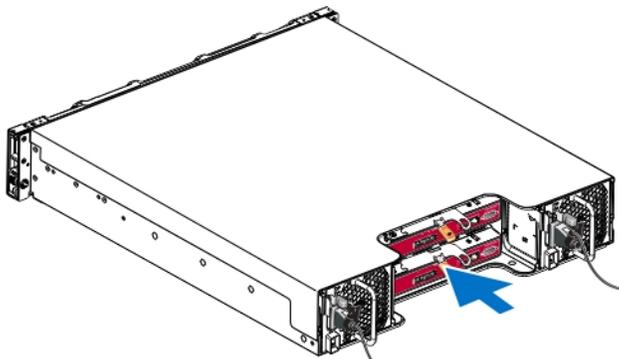
4. 将拉杆向内转动，会将控制模块完全推入插槽。拉杆上的闩锁会弹入相应位置。
