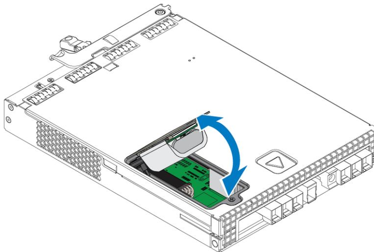
5. Le connecteur qui se connecte à la batterie est maintenu en place par un clip de retenue, qui doit être enfoncé pour retirer le connecteur (Figure 24). Saisissez l'extérieur du connecteur, tout en enfonçant simultanément le clip de retenue, et faites bouger doucement le connecteur d'un côté à l'autre tout en tirant vers l'extérieur pour le retirer. Mettez l'ancienne batterie de côté.
