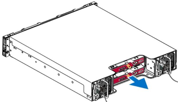
3. Placez le module de contrôle sur une surface plane où il sera protégé contre toute décharge électrostatique. Afin d'éviter tout dommage, ne placez rien sur le module de contrôle.
