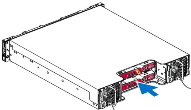
4. Tournez le levier vers l'intérieur : le module de contrôle est entièrement poussé dans le logement. Le loquet du levier s'enclenche.
