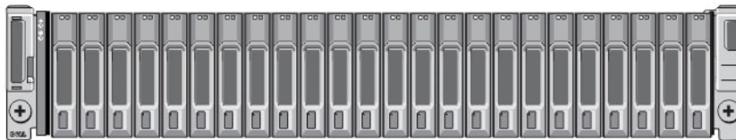
그림 4. 2.5인치 드라이브 어레이 - 전면 모습(베젤 없음)
