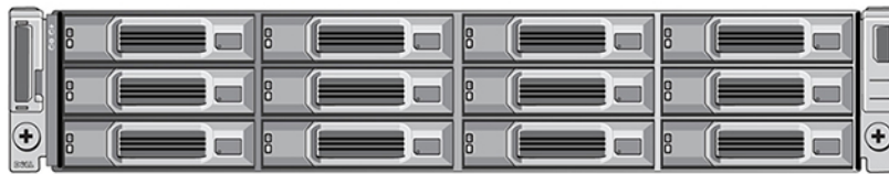
그림 3. 3.5인치 드라이브 어레이 - 전면 모습(베젤 없음)
