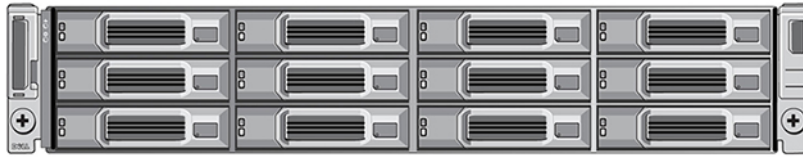
Ilustración 3. Arreglo con unidades de 3,5 pulgadas - Vista anterior (sin bisel)
