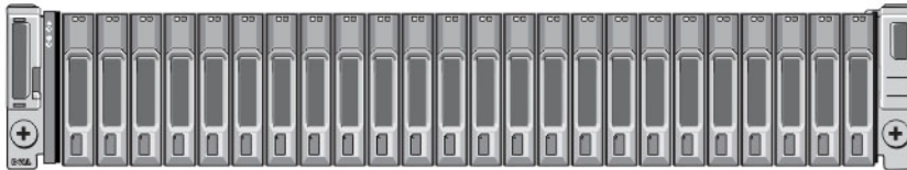
Ilustración 4. Arreglo con unidades de 2,5 pulgadas - Vista anterior (sin bisel)
