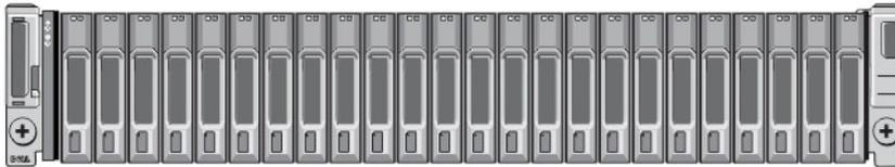
**Abbildung 4. 2,5-Zoll-Laufwerkarray - Vorderansicht (ohne Blende)**
