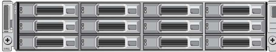
Şekil 2: 3,5 İnç Sürücü Dizisi - Önden Görünüm (Çerçevesiz)
